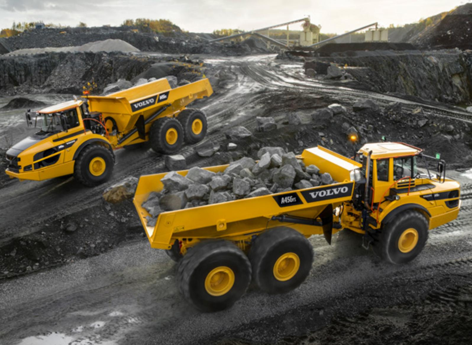
Volvo knickgelenkte Dumper 41 Tonnen 485 PS
